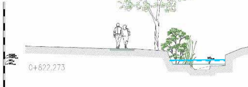
Ausgleich der Rauheitserhöhung durch **Böschungsbewuchs** durch entsprechende Querschnittsaufweitung
